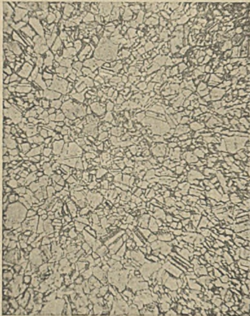
Abbildung 1. Gefügebild von Messing.
