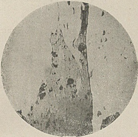
Abbildung 3. Einschluß in Frischfeueisen vor der Reduktion mit Wasserstoff.
