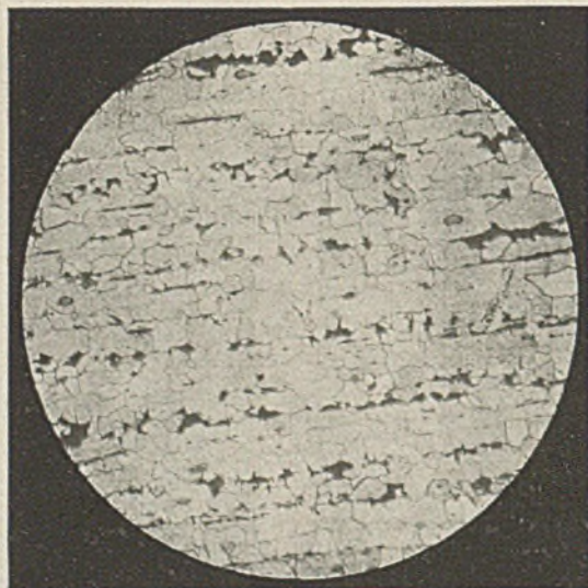
Abbildung 16. Probe 7 L, 1 Stunde bei 920° ge- glüht, im Ofen abgekühlt.
