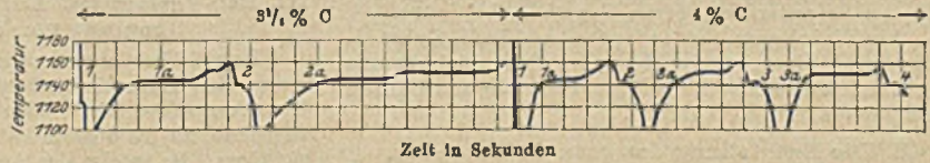
Abbildung 2. Erhitzungs- und Abkühlungskurven von Eisen-Kohlenstoff-Legierungen mit 3\frac{1}{2}\% und 4\% C.
