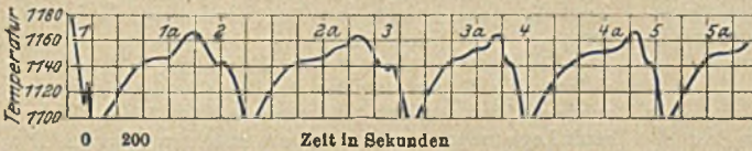
Abbildung 1. Erhitzungs- und Abkühlungskurven einer Eisen-Kohlenstoff-Legierung mit 2\frac{1}{2}\% C.
