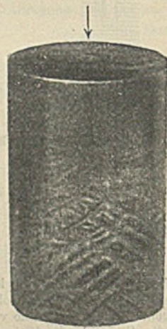
Abbildung 3. Gedrückte äußere Walze.
