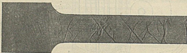
Abbildung 2. Gezogener kantiger, schweißeiserner Stab.
