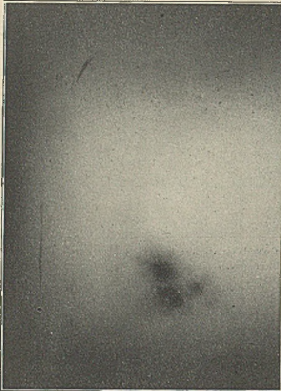
Abbildung 33. Gußeisenstück, 42 mm stark, mit zu kleinem Bleiumguß und deshalb zu starker Unterstrahlung.
