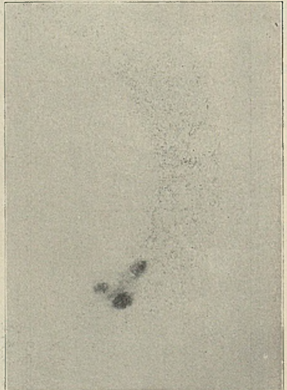
Abbildung 34. Dasselbe Stück Gußeisen wie in Abb. 33, nur mit weiter ausgedehntem Bleischutz und deshalb fehlender Unterstrahlung. (Bei der Wiedergabe seitenverkehrt ausgefallen.)
