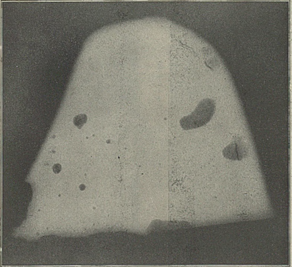
Abbildung 27. Gußstück, in der Mitte 4 mm, nach außen hin bis 8 mm dick.
