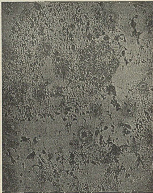
Abbildung 1. Feinvorteilter, knotenförmiger Graphit in einem Holzkohlenroheisen. Ungeätzt.
