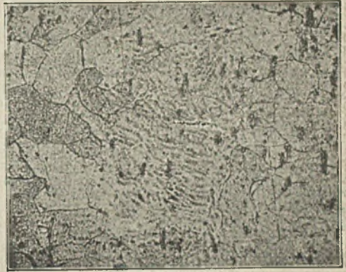
Abbildung 1. Schweißisenprobe mit 0,356 % durchschnittlichem Phosphorgehalt. Längsschnitt. Gesprenkeltes und grobkörniges Ferritgefüge. Geätzt mit 10prozentiger alkoholischer Salpetersäure. \times 66
