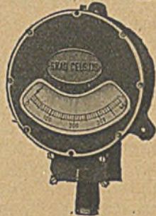
Abbildung 4. Temperaturzeiger für Betriebsmessungen. Wasserdichtes Instrument.
