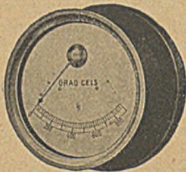
Abbildung 3. Temperaturzeiger für Betriebsmessungen. Wandinstrument.
