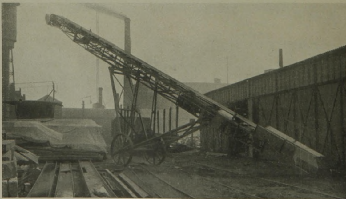
FÖRDERBAND VON 15 m FÖRDERLÄNGE MIT HÖHENVERSTELLUNG UND AUFGABESCHURRE
