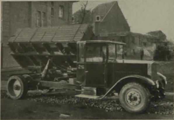
ABB. 31. DREISEITENKIPPER FÜR 5 t NUTZLAST Friedr. Krupp, A.-G., Essen
