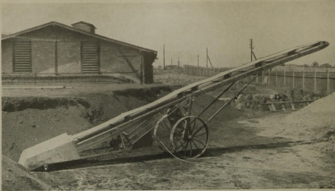
FAHRBARER GURTFÖRDERER MIT HÖHENVERSTELLUNG UND 8, 10, 12, 15 u. 20 m ACHSABSTAND AT G-Allgemeine Transportanlagen-Gesellschaft, Leipzig
