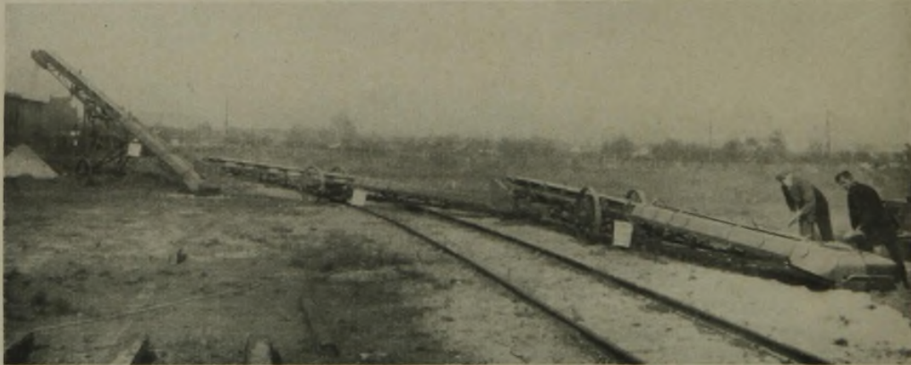
HINTEREINANDER GESCHALTETE FAHRBARE TRANSPORTBÄNDER Abb. 21. u. 22. Wolf Netter & Jacobi-Werke, Abteilung Förderanlagen, Berlin
