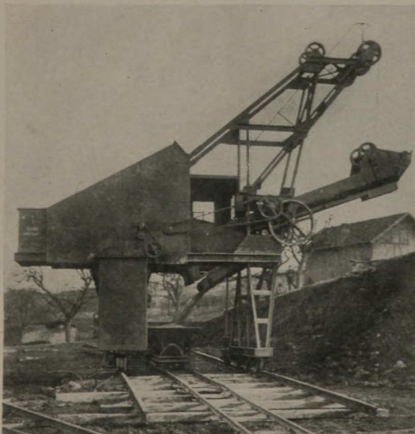
PORTAL-SCHAUFELBAGGER DER A.-G. FRIEDRICH KRUPP, ESSEN Elektr. Antrieb, Schaufelbagger mit 50 cbm. Stundenleistung in einer Tongrube arbeitend, 8 m größte Abtragshöhe
