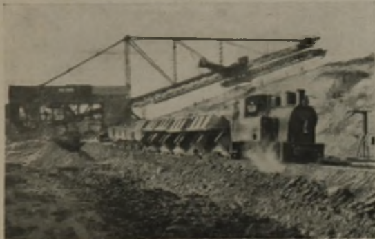
ABB. 13. ABSETZER 18 m SCHÜTTHÖHE, 40 m SCHÜTTWEITE Friedrich Krupp A.-G., Essen. Lübecker Masch.-Fabrik usw.
