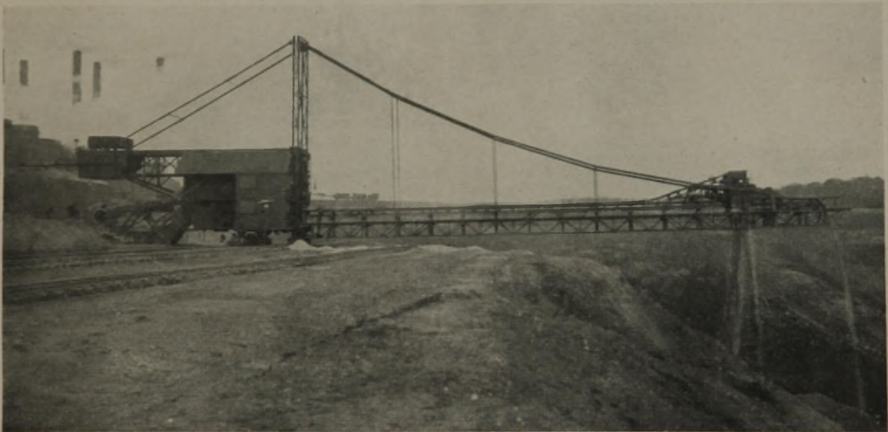
ABSETZAPPARAT MIT GURTFÖRDERER UND ABWURFWAGEN IM ABRAUM EINER BRAUNKOHLGRUBE ARBEITEND. Friedrich Krupp A.-G., Essen Höchstleistung in 10 Stunden 6000—5000 cbm
