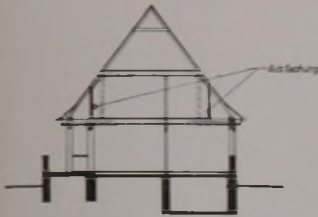
Bild 1. Gebäudequerschnitt mit Schema des Ausbaues der Dachschrägen. An Stelle des Daches mit doppeltem Stuhl ist eine stützen- und strebenlose Dachkonstruktion anzuwenden, um den gesamten Raum frei und nach Bedarf aufteilen zu können.
