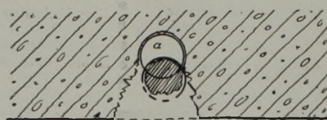
Poröser Beton ermöglichte das Rosten der Eisenstäbe. Der Beton wurde abgesprengt, das Eisen vom Rost zerstört. a = ursprünglicher Platz des Bewehrungsstabes.
