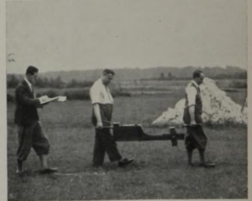
Als Ergebnis jahrelanger Versuche und gesammelter Erfahrungen in der Geophysik wurde in dem „Geoskop“ ein elektrisches physikalisches Meßgerät entwickelt, das die feinsten Unterschiede im Aufbau des Bodens durch Zeigerausschläge registriert und im Gelände ein deutliches Bild vom Aufbau und der Beschaffenheit des Untergrundes gibt und die Bodenschichten mit ihren Einzelheiten tatsächlich so darstellt, wie sie in Wirklichkeit unter der Erde liegen.
