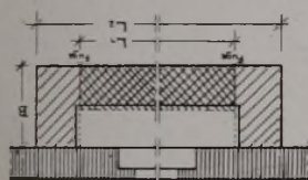
Verschiedenes Aufmaß bei Liefern und Verlegen von Werksteinstufen.
