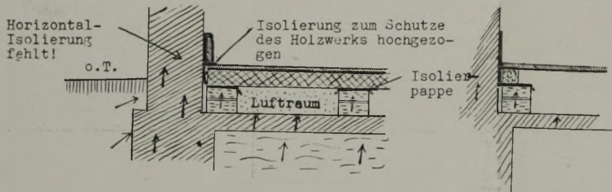
Abb. 1. Ungenügende Isolierung der Lagerhölzer
