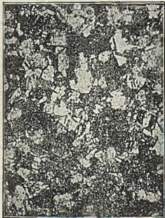
Abbildung 4. Gewalztes Kupfer nach dem Glühen bei 650 bis 700° 40 min lang.
