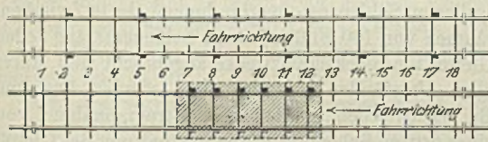
Abbildung 92 und 93. Falsche und richtige Verteilung der Klemmen.
