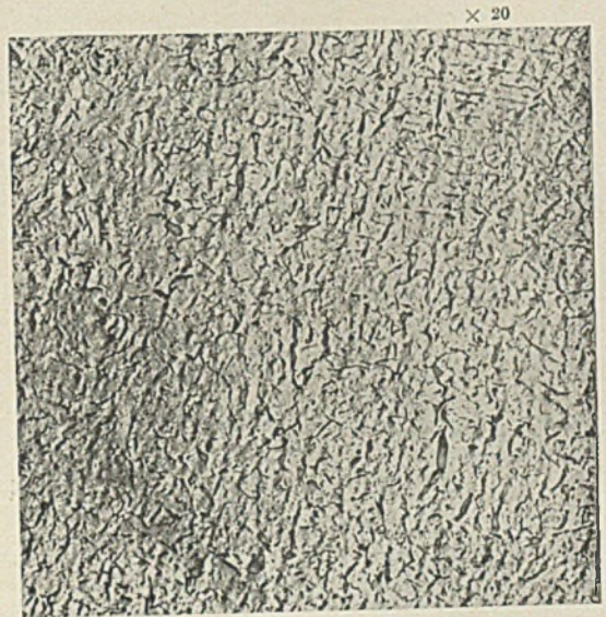
Abbildung 21. Graues Gußeisen mit 0,09 % Mangan.
