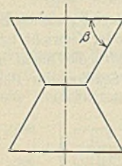
Abbildung 5. Doppelkegel beim Druckversuch.
