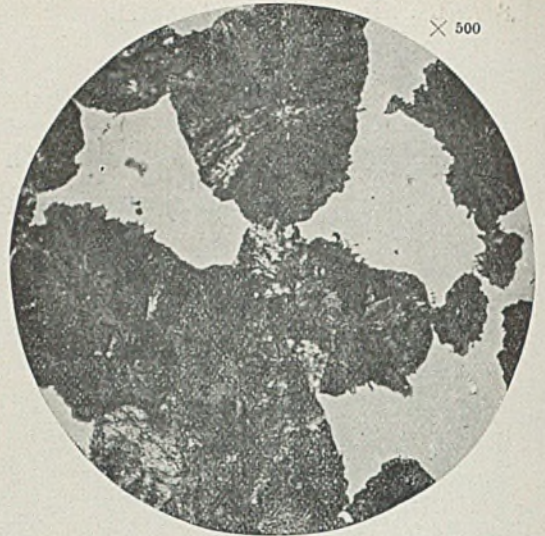
Abbildung 15. Martensit mit Osmondit. Stelle vom Inneren Rande des zweiten Martensitringes in Probe Abb. 11.
