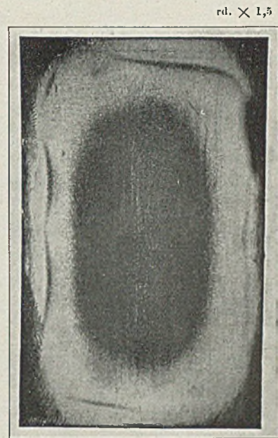
Abbildung 13. Längsschnitt durch abgeschreckten Zylinder, geätzt. Die dunkle Außenkante rührt vom runden Abschleifen her, ist also keine Spiegelung; sie bestand auch aus Martensit (Material Stahl B).
