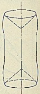
Abbildung 24. Tonnenform am Ende der Preßflächen.
