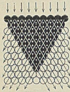
Abbildung 16. Druckverteilung bei Beginn des Pressens.
