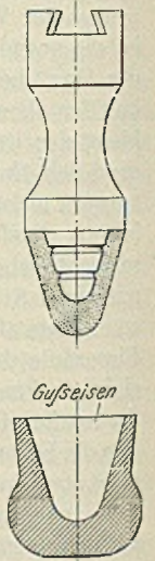
Abbildung 4. Auswechselbares Mundstück und Büchse zum Abdücken des Pfropfens.
