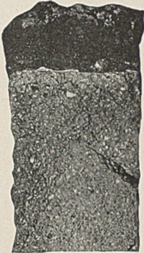
Abbildung 1. Stein, durch Schlacke angegriffen.
