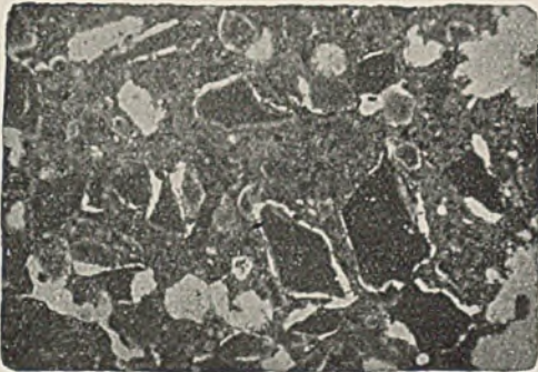
Abbildung 3 Dünnschliff (einzelne Körner vom Bindeton losgelöst).
