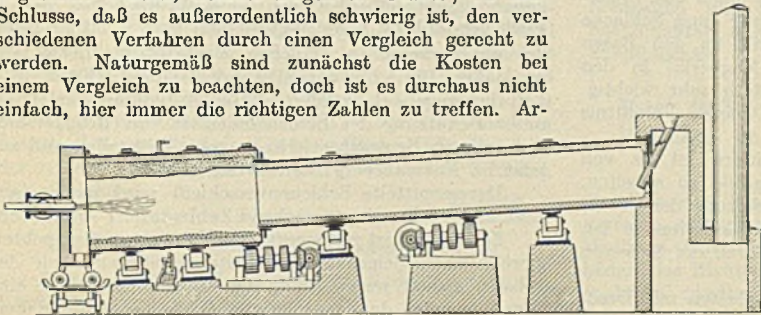
Abbildung 1. Drehofen nach Ross mit schwingendem Endteil zur Bekämpfung der Ansätze.
