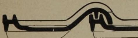
Querschnitt durch den Falzenschluß (1:5)
