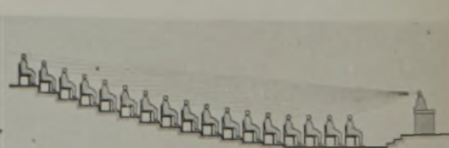
Abb. 9. Kanzel-Tiefstellung bei Sitz-Überhöhung. Akustisch günstig: Gleicher Schallempfang wie bei Kanzel-Hochstellung.
