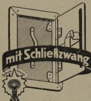
**Johns** Schornsteinfür, das Vorbild aller Schließzwangtüren, schützt vor Brandschäden, weil der Schlüssel nur abgezogen werden kann, wenn die Tür ordnungsgemäß geschlossen ist. Von Baufachleuten, staatl. und staatl. Behörden bevorzugt. Aus S-M-Stahlblech, feuersicher, unbedingt zuverlässig, dicht schließend, mit seitlich zu öffnender oder herabfallender Innentür, auch in gasdichter Ausführung für Schutzräume. Prospekt S164 und Angebot kostenlos.
