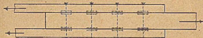
**4 Der Kübler'sche Scheibendübel.** Die Dübel können etwas versetzt angeordnet werden, damit die Scherfläche größer wird, siehe Figur c. Zeichnung des Verfassers
