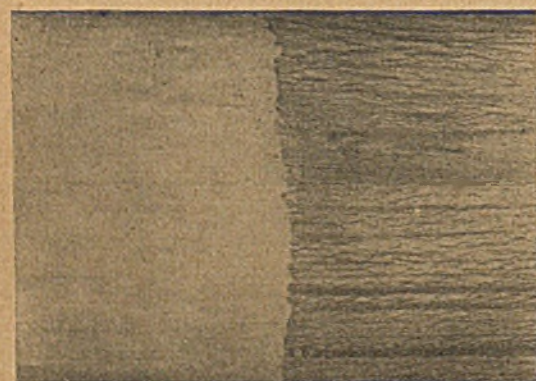
5 Erkalith-Anstrich gegen Hausbock. 6 Bespritzen einer Wand mit Schwammenschutz „Rütgers“
