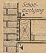
1 Schalldurchgang am Streichbalken
