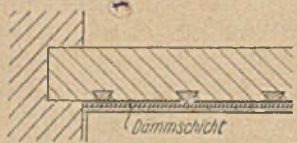
5 Dämmschicht an der Deckenunterseite, wenig wirksame Anordnung
