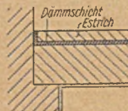
4 Dämmschicht gegen Luftschall-Übertragung, wenig wirksame Anordnung
