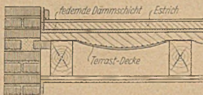
14 Terrastdecke mit federnder Dämmschicht
