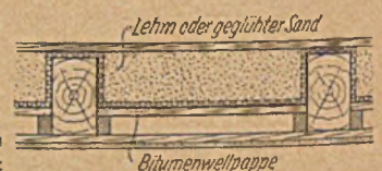
10 Holzbalkendecke mit normalem mindestens zu forderndem Schallschutz
