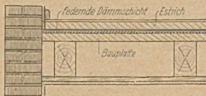
15 Holzbalkendecke mit Leichtbauplatten und schwimmendem Estrich
