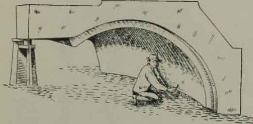
Abbildung 5. Zur Fertigausarbeitung und zum Trocknen abgesetztes Oberteil.
