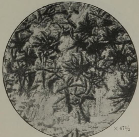
Abbildung 9. Zu Abb. 5: Form des Kohlenstoffs.
