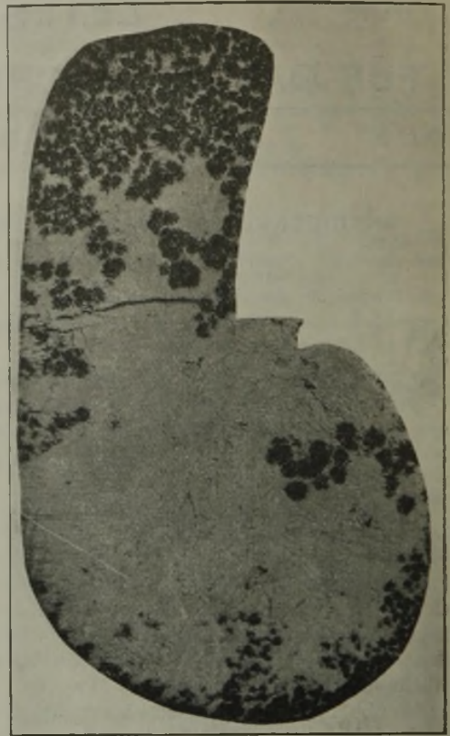
Abbildung 6. \times 3\frac{3}{4} Umgekehrter Hartguß in einer Eisen-Kohlenstoff-Legierung.
