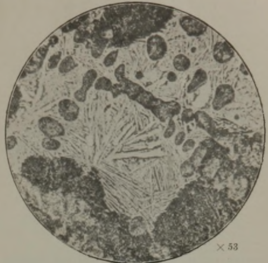
Abbildung 4. Harte Stelle: reiner Ledeburit, zu Abb. 3.
