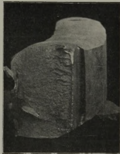
Abbildung 6. \times 1/1 Geschmiedete „Mattschweiße“.
