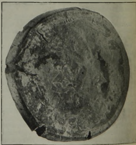
Abbildung 14. Langriß in einer gestauchten Scheibe. × 1/10
