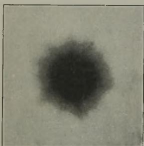
Abbildung 5. Röntgenstrahlenbild von weichem Blockmaterial.
