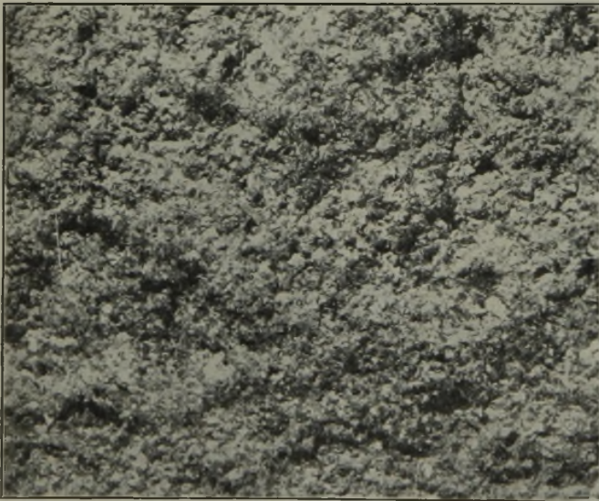
Abbildung 9. Ausgefüllter Schwindungshohlraum. \times \frac{1}{10}
