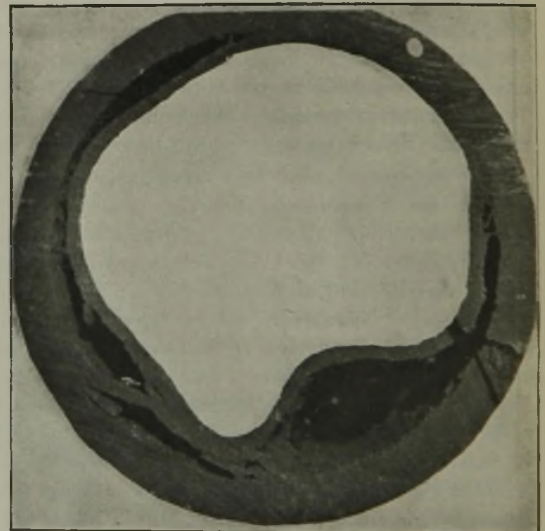
Abbildung 20. Verschiebung des Lunkers bei der Herstellung eines Hohlkörpers durch Pressen.
