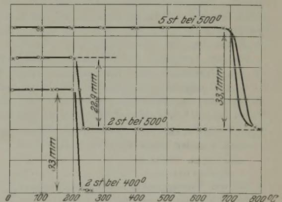
Abbildung 6. Abnahme des Magnetausschlags für verschieden gegläute Proben reinen perlitischen Zementits.
