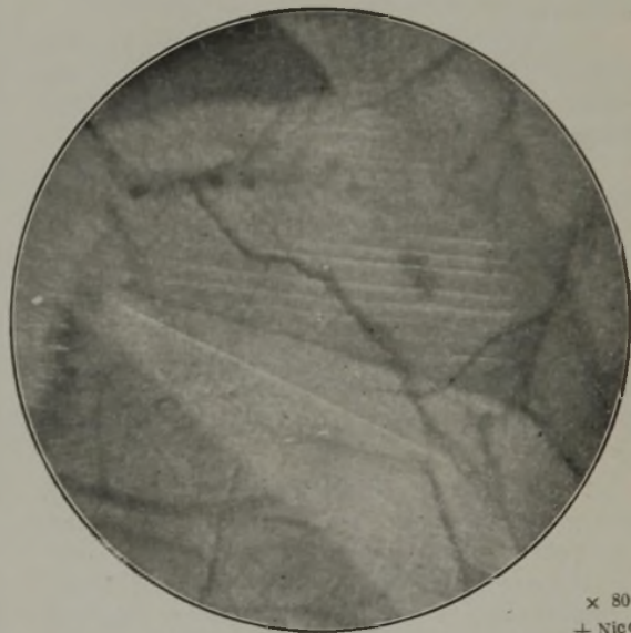
Abbildung 10. Versuch 10. Aus Schlacke 8 (Abb. 7) durch Einschmelzen von Tonerde (Abb. 8) und darauffolgendem Anreichern mit Kalk (Stückschlacke). Typischer Anorthit, verzwilligt nach dem Albitgesetz, daneben Melilith; der Olivin (in Abb. 8) ist verschwunden.
