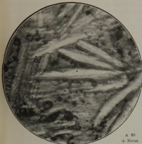
Abbildung 7. Versuch 9. Ausgangsschlacke 8 (Dünnschliff von Stückschlacke). Typische Melilithe in ausgebildeten Kristallen (kein Olivin).
