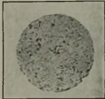
Abbildung 3. Schliffbild des Zerreißstabquerschnitts 5 mm, ungeätzt.
