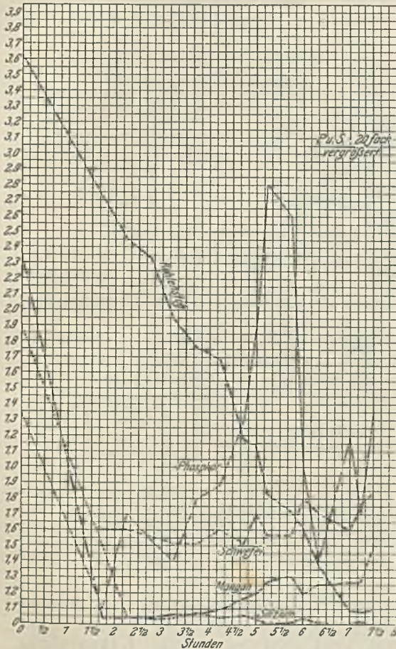
Abbildung 6. Verbrennungskurven der Metalle (Charge 4850, Hubertushütte).
