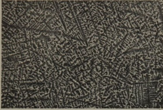
Abbildung 16. Dendritische Struktur des Gußblockes für eine Panzerplatte.
