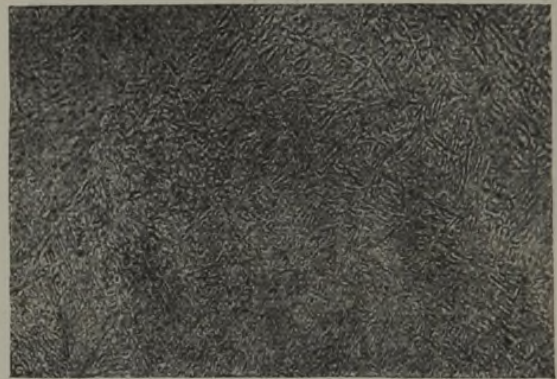
Abbildung 26. Gefüge der Rückseite der Platte nach der Oelhärtung.
