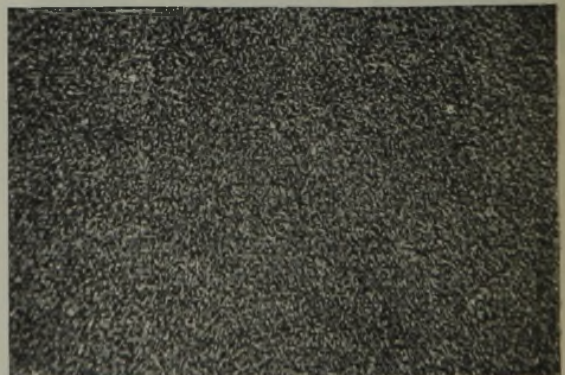
Abbildung 32. Gefüge der Rückseite der Platte nach der Schlußhärtung.
