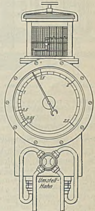
Abbildung 13. Minimaldruckmesser System Schultze-Dosch mit Registrierung.
