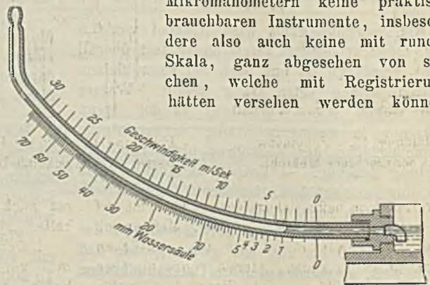
Abbildung 10. Skala zum Manometer mit gebogenem Meßrohr.
