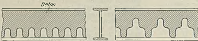
Abbildung 5. Anwendung des Doppel-Wellblechs zu Deckenbauten.
