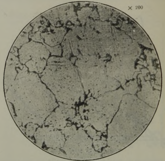
Abbildung 11. Werkstoff A 2 O. Korngefüge der um 10% gestauchten, bei 800° geglähten Proben.
