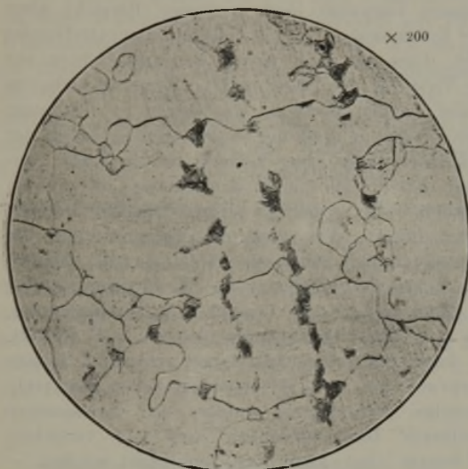
Abbildung 20. Werkstoff Ka, um 10% gestaucht, bei 700° gegläht.
