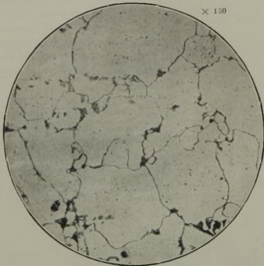
Abbildung 10. Werkstoff K. Korngefüge der um 10% gestauchten, bei 800° geglähten Proben.
