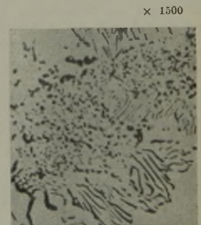
Abbildung 2. Weicher Stahl. Körniger und lamellarer Perlit. Natrium-Pikrat-Aetzung.
