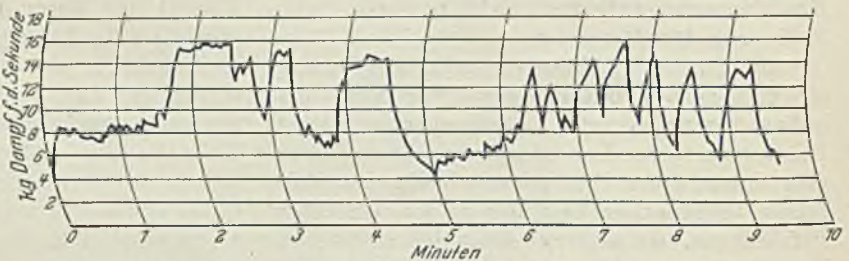
Abbildung 4. Schwankungen in der Hauptdampfleitung eines Walzwerks.
