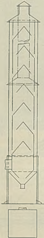
Abbildung 31. Schlauchloser Trocken-Staub- sammler nach H. Hees.
