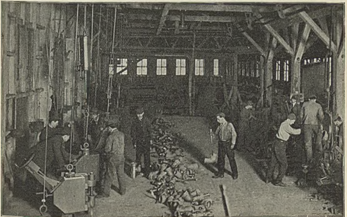
Abbildung 10. Ausziehen des Kerns mittels Hebezeug.
