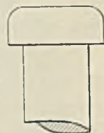
Abbildung 2. Flacher Nietkopf ohne „konischen Uebergang“ zum Schaft.
