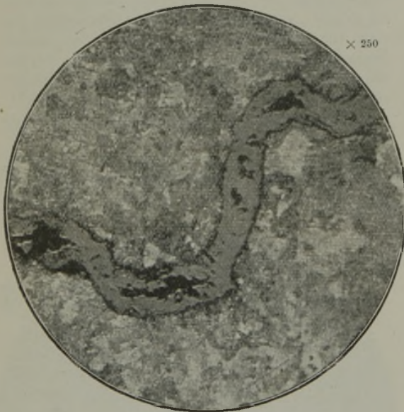
Abbildung 4. Flockenstelle quer auf ihre Längserstreckung geschliffen und mit alkoh. \text{HNO}_3 geätzt.
