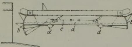
Nach der Erfindung werden die Stirnseiten der im Hauptpatent beschriebenen Löschkpfanne a mit Drehklappenverschlüssen versehen, die vom Führerstand aus durch eine Zugvorrichtung e bedient werden können. Zweckmäßig versieht man jede Klappe b mit einem Gegengewicht d und bringt eine Sperrvorrichtung c an, die die Öffnungsklappe festhält.
