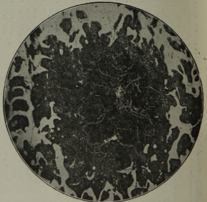
Abbildung 14. Perlitnest mit Graphitausscheidungen in der Grenzzone.
