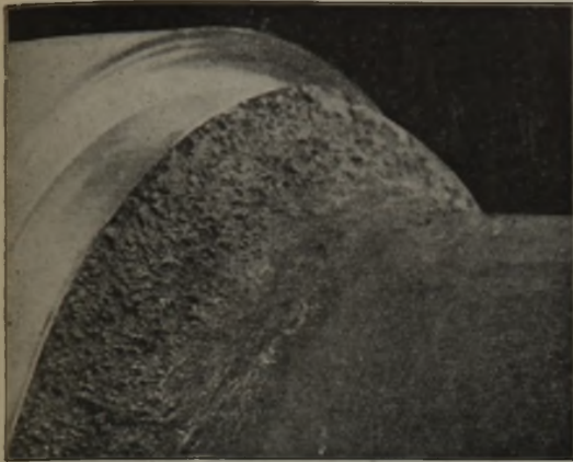
Abbildung 15. Oberes Ballenende einer Hartgußwalze mit ausgepreßten Tropfen.
